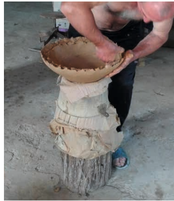
Qvevris werden aus mehreren Tonschichten aufgebaut
